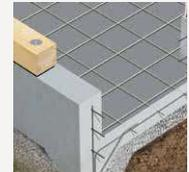
公庫基準を超える鉄筋を採用。直径13mmの太い鉄筋をプランや積雪量に応じて150~200mmの細かな間隔で組む、基礎強度の高い構造。※計算により変わります。
